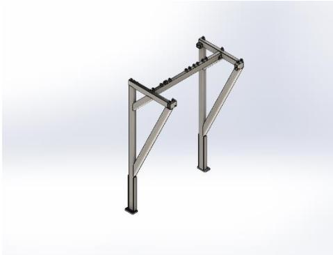
3- Posicionar las barras de apoyo delantero en las sujeciones de cabina y a su vez unirlas con los apoyos laterales de chasis. Atornillarlas a las escuadras del chasis de cabina.
