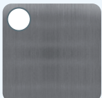
X02: AISI 441 SB Scotch Brite
